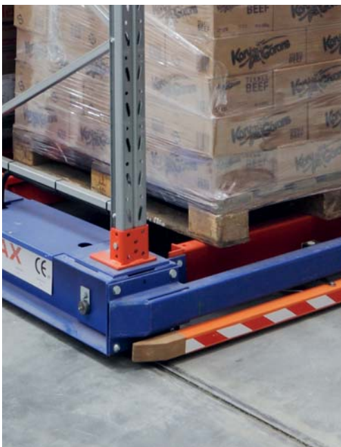
Vagnarna går på löpräls och styrräls som är nergjutna i betonggolvet.
