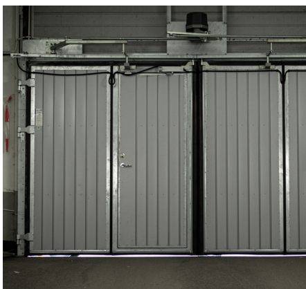
Vikport med lackerad profilplåt, 4-delad, inåtgående med maskindrift och gångdörr.
